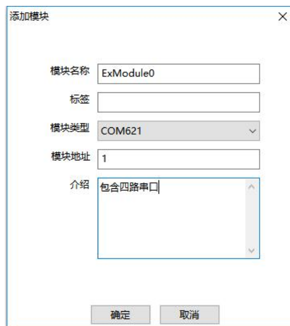
图 3-11 添加串口通信设备
