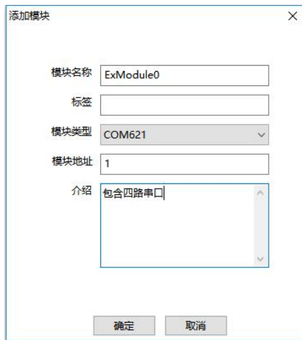
图 3-16 添加串口通信设备
