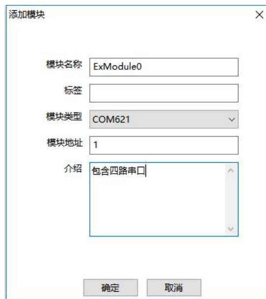
图 3-1 添加串口通信设备
